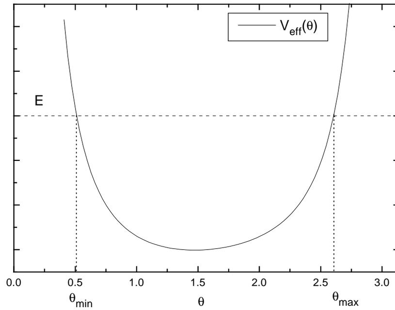
Figura 2: Potenziale  $V_{\text{eff}}(\theta)$ : per ogni valore di  $E$  si ha un moto periodico compreso tra  $\theta_{\text{min}}$  e  $\theta_{\text{max}}$ .
