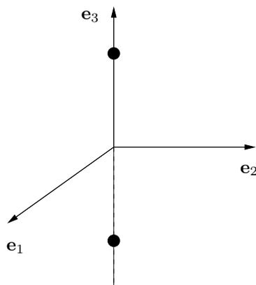
FIGURA 42.2. Assi d'inerzia di un sistema costituito da due punti materiali.
