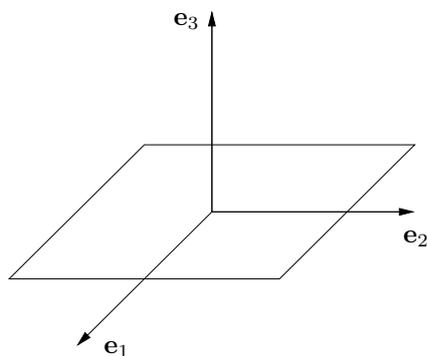
FIGURA 42.9. Assi d'inerzia di una lamina rettangolare.
