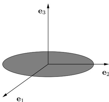
FIGURA 42.5. Assi d'inerzia di un disco sottile.
