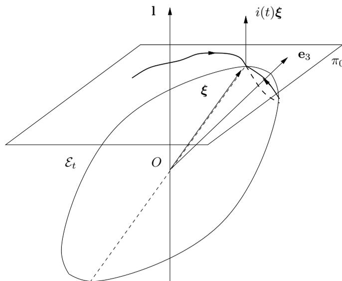
FIGURA 45.1. Descrizione del moto secondo Poincaré. L'asse di moto, individuato dalla retta d'azione del vettore  $\xi$ , descrive una curva chiusa sull'ellissoide d'inerzia (poloide) e una curva sul piano  $\pi_0$  (erpoloide).
