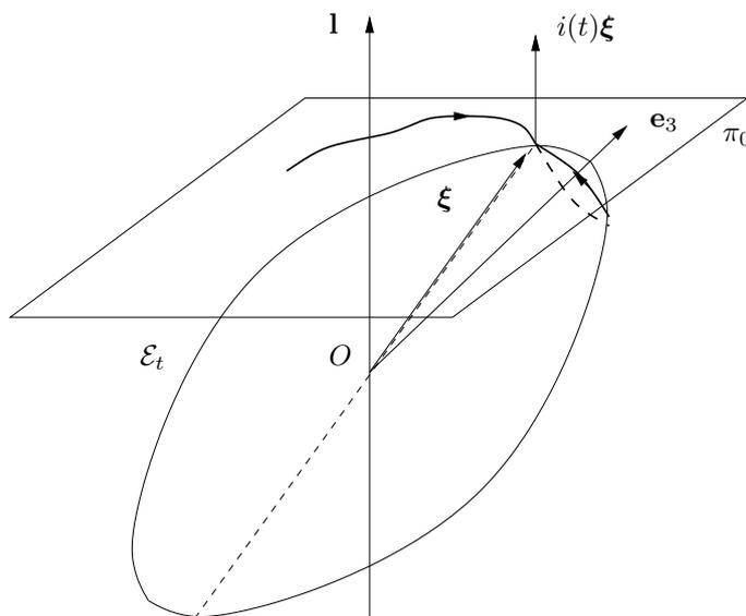
FIGURA 45.1. Descrizione del moto secondo Poinrot. L'asse di moto, individuato dalla retta d'azione del vettore  $\xi$ , descrive una curva chiusa sull'ellissoide d'inerzia (poloide) e una curva sul piano  $\pi_0$  (erpoloide).
