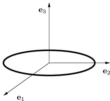
FIGURA 42.4. Assi d'inerzia di un anello sottile.
