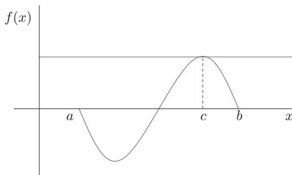
Figura 8.1: Significato geometrico del teorema di Rolle.
