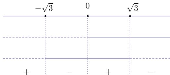
Figura 9.14: Studio del segno della derivata seconda della funzione dell'esercizio 4.
