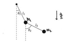
Si scriva la lagrangiana del sistema nelle coordinate  $(\theta_1, \theta_2, \dot{\theta}_1, \dot{\theta}_2)$ , e la si usi per derivare le equazioni del moto sul vincolo. Si riconosca che tali equazioni sono le stesse derivate a esercitazioni con il metodo di eliminazione delle reazioni vincolati:
